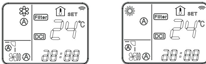
Presionar simultáneamente los pulsadores FAN + I FEEL durante mas de 7 segundos y soltarlos dirigiendo el mando a distancia hacia el receptor de la unidad interior. Asegúrese de enviar la señal a una sola unidad interior y que no hay otras unidades interiores que podrían recibir la misma señal.
